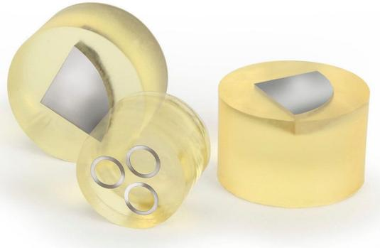
(b) Montaje de especímenes en resina epóxica [88].
