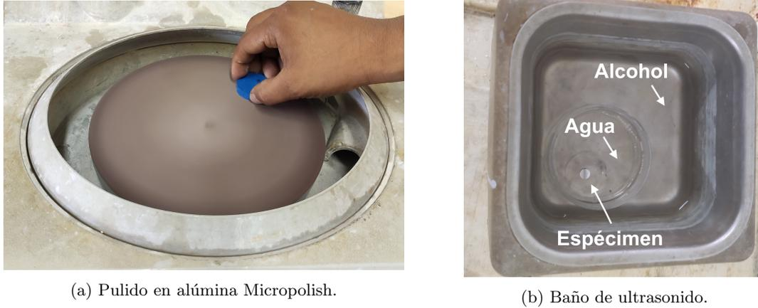
Figura 5.15: Pulido y baño de especímenes de acero.
