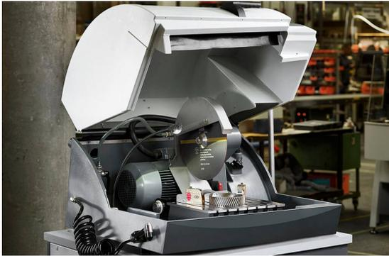
(a) Máquina de corte *Labotom-5* [87].
