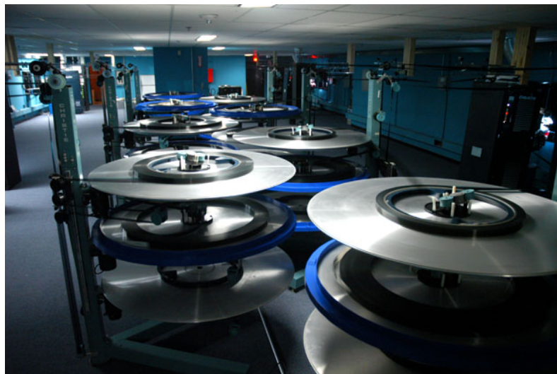
(b) Sistemas de platos para arrastre de película de 35mm, marca Christie.
