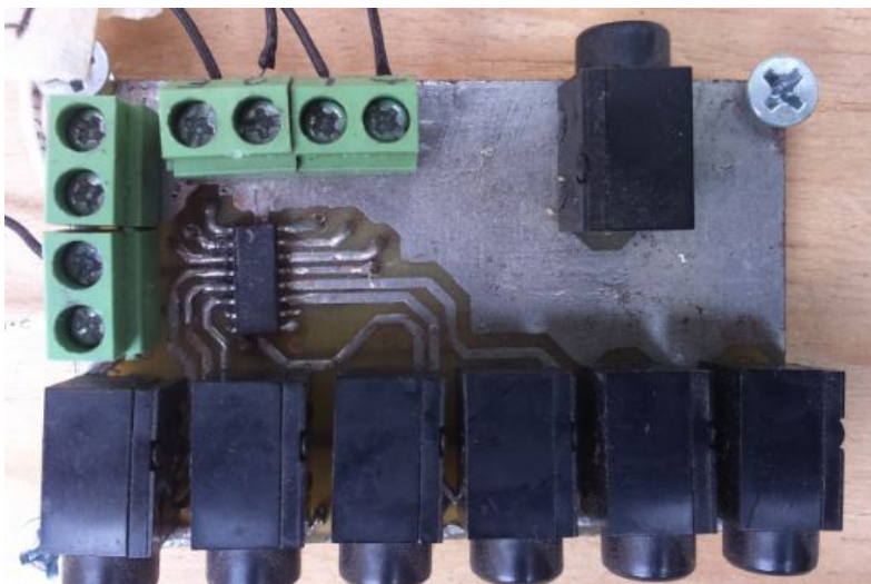
Figura 8: Circuito de tarjeta multiplexora de salida de audio.
