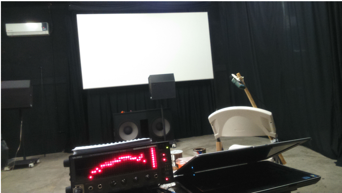
Figura 27: Respuesta de canal izquierdo a la reproducción del ruido blanco visto en el RTA.
