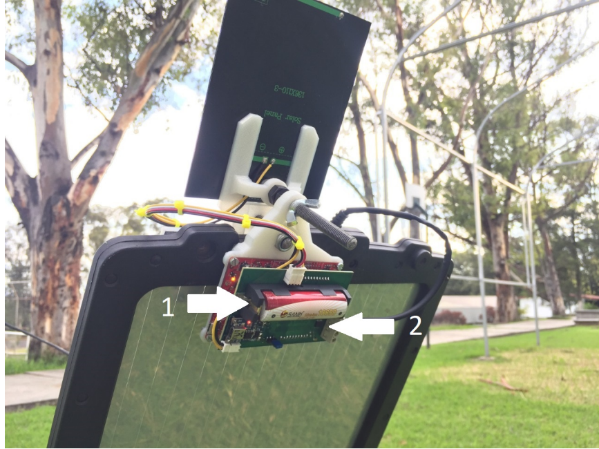
Figura 4.15: Sistema de medición montado sin cobertura (vista trasera) (1) batería del sistema-IoT, (2) sensor de parámetros eléctricos.
