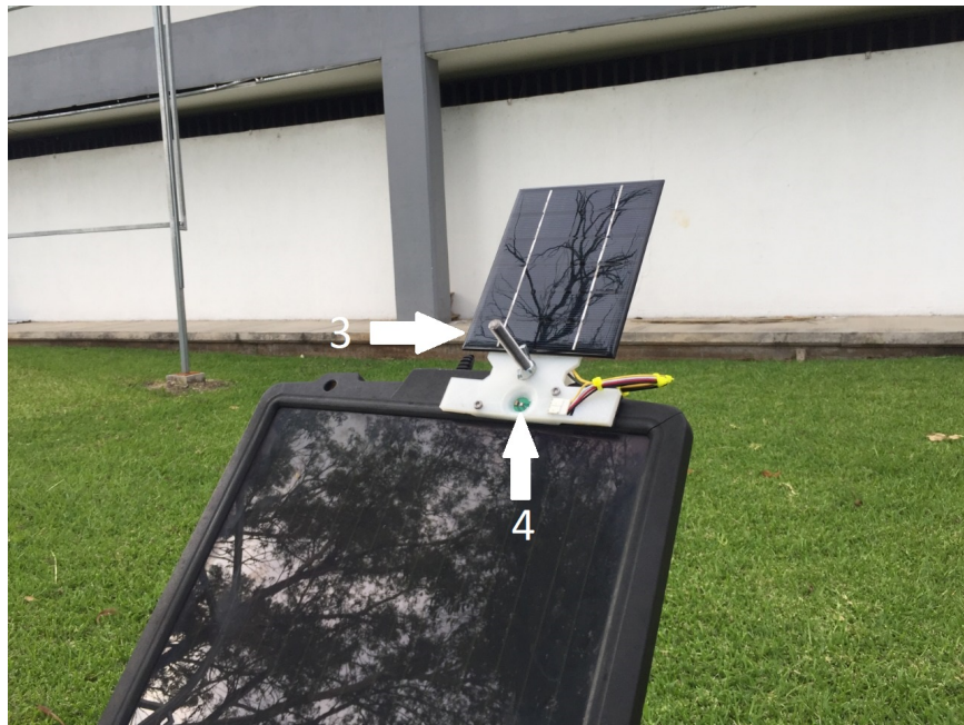
Figura 4.16: Sistema de medición montado sin cobertura (vista delantera) (3) panel solar para carga de batería (4) sensor de luz.
