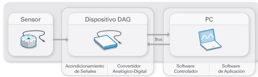
Figura 2.1: Partes de un sistema DAQ.
